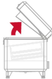
**1** Lorsque les dispositifs de verrouillage de porte sont ouverts, la porte d'accès supérieure reste dans une position fixe ouverte, facilitant ainsi la maintenance.
