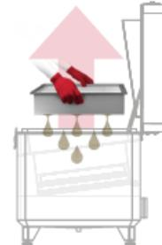
**3** Lorsqu'elles sont maintenues et déplacées vers le haut, les gouttes de particules d'huile restent à l'intérieur du collecteur de brouillard d'huile.
